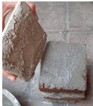
Gambar 3. 22 Menutup Benda Uji dengan Plywood yang Sudah Dilapisi dengan Mortar
