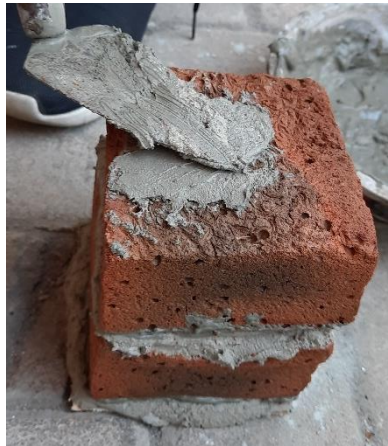
Gambar 3. 21 Melapisi Bidang Atas Benda Uji dengan Pasta Semen
