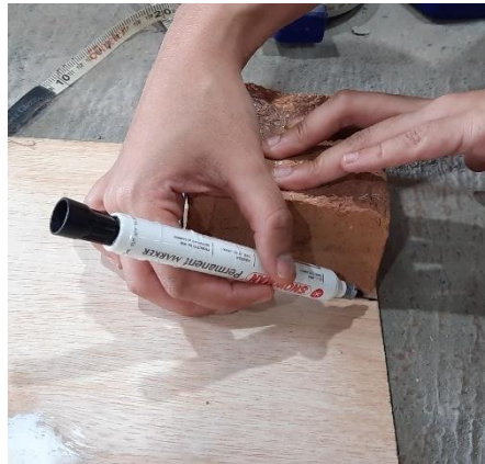
Gambar 3. 10 Menyiapkan Plywood Seukuran Benda Uji
