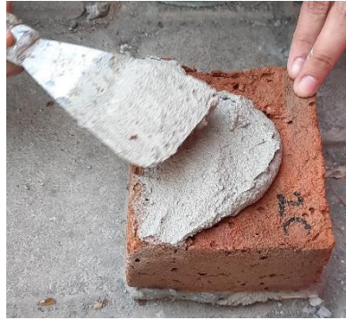
Gambar 3. 18 Melapisi Benda Uji 1 dengan Mortar
