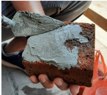
Gambar 3. 19 Melapisi Benda Uji 2 dengan Pasta Semen
