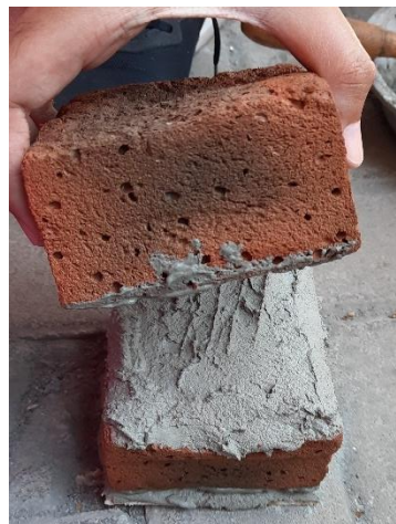
Gambar 3. 20 Menggabungkan Benda Uji 1 dan Benda Uji 2
