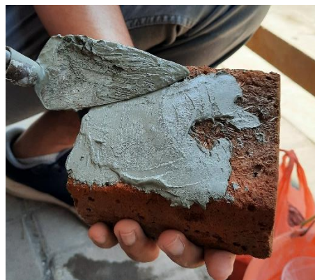
Gambar 3. 17 Melapisi Benda Uji 1 dengan Pasta Semen
