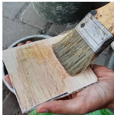
Gambar 3. 11 Mengolesi Plywood dengan Oli
