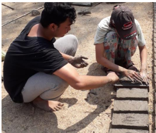
Gambar 3. 5 Proses Pencetakan dan Pematatan Benda Uji
