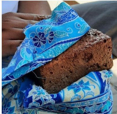
Gambar 3. 15 Mengeringkan Benda Uji dengan Kain Bersih
