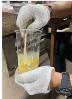
Gambar 3. 28 Proses mengaduk campuran Epoxy Resin dan Hardener selama proses pengeleman
