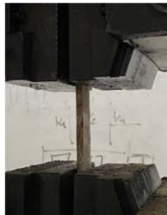
Gambar 3. 46 Proses Akhir Pengujian Kuat Tarik Ditandai dengan spesmen uji yang patah
