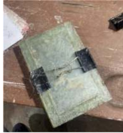
Gambar 3. 29 Penjepitan Benda Uji menggunakan Jepitan Kertas
