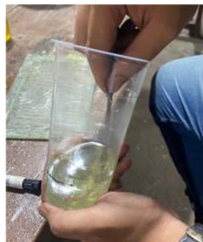
Gambar 3. 26 Proses mengaduk campuran Epoxy Resin dan Hardener
