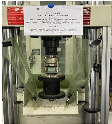
Gambar 3. 12 Uji Kuat Mortar
