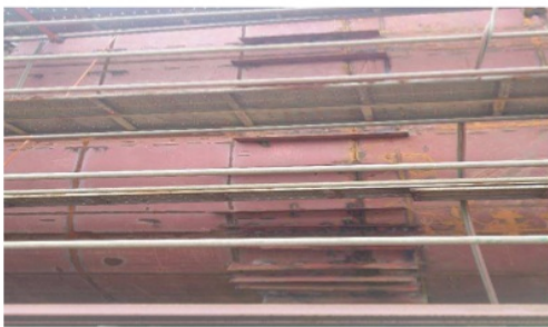
Gambar 6. Hasil penyetulan block setelah di ukur gap-nya.
