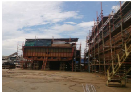
Gambar 2. Pembangunan kapal sistem block
