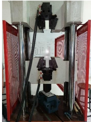
Gambar 3. 5 Pengujian Kuat Lentur
