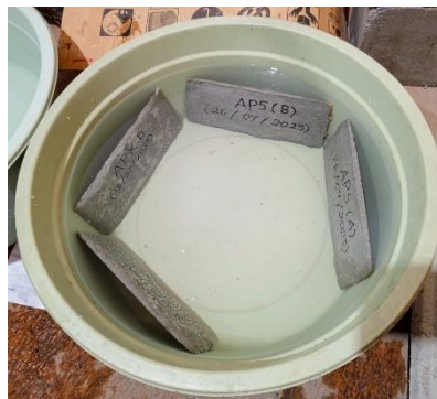
Gambar 3. 3 Uji Penyerapan Air
