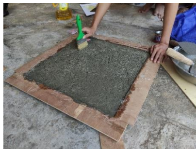
Gambar 3.19 Penekanan Fiberglass Dan Limbah Rambut Dengan Kuas
