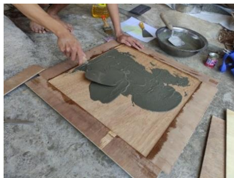
Gambar 3.17 Penuangan Adonan diatas Cetakan Plafond
