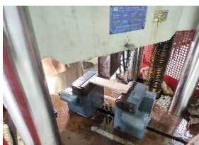
Gambar 3.32 Mencatat Jarak Sangga Benda Uji Dan Mesin UTM
