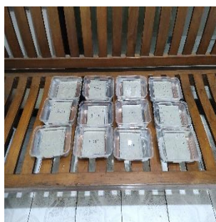
Gambar 3.29 Perendaman sampel selama 24 jam.
