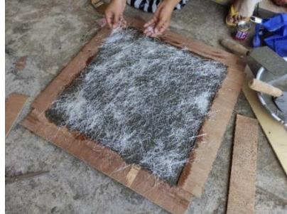
Gambar 3.18 Penaburan Fiberglass Dan Serat Limbah Rambut
