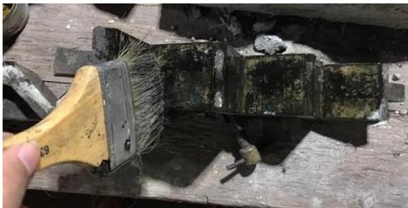
**Gambar 3.24** Cetakan dilumuri minyak
