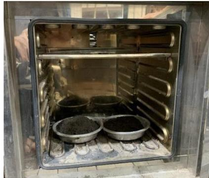
**Gambar 3.1** Agregat halus yang akan dikeringkan dalam oven
