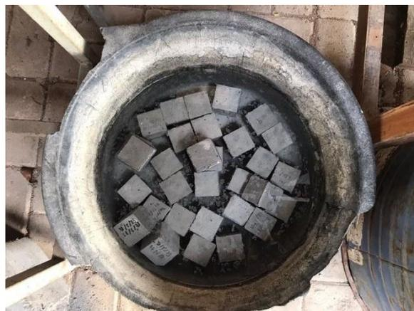
**Gambar 3.26** Benda uji mortar dalam proses *curing*
