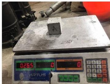
**Gambar 3.28** Timbang benda uji
