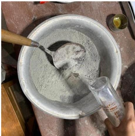
**Gambar 3.23** Pemberian air untuk pencampuran bahan
