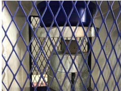
**Gambar 3.29** Pengujian kuat tekan mortar
