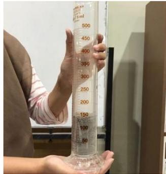
**Gambar 3.3** Gelas ukur yang sudah terisi pasir
