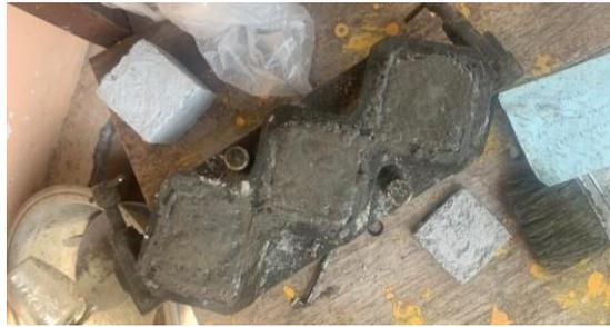
**Gambar 3.25** Pasta mortar basah dalam cetakan
