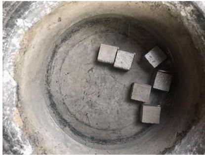
**Gambar 3.27** Benda uji mortar yang dicuring
