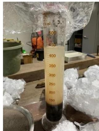
**Gambar 3.7** Hasil dari pengujian kadar lumpur
