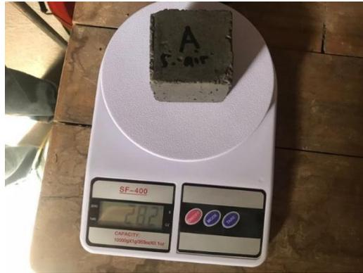
**Gambar 3.32** Timbang mortar setelah permukaan dilap
