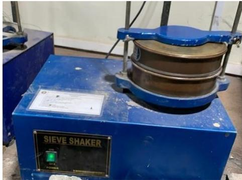
**Gambar 3.21** Saring pasir dengan bantuan alat *sieve shaker*
