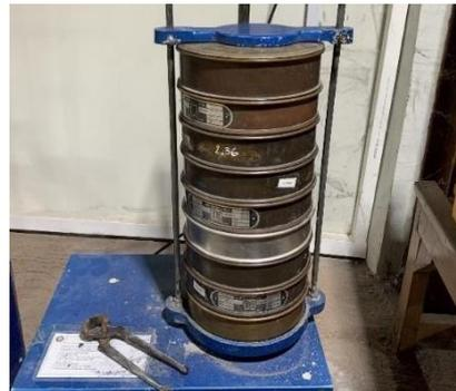
**Gambar 3.2** Agregat halus yang sudah dioven dimasukkan dalam saringan
