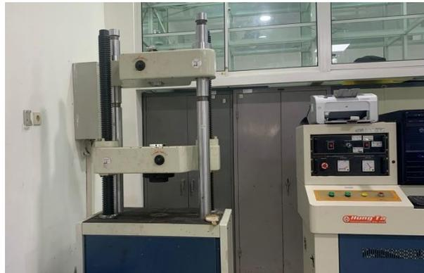
Gambar 3. 4 Mesin Uji Beban Lentur
