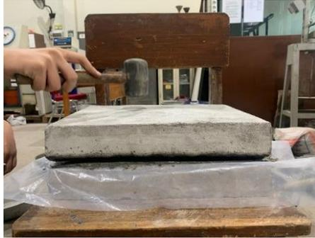
Gambar 3. 12 Cetakan Genteng Beton
