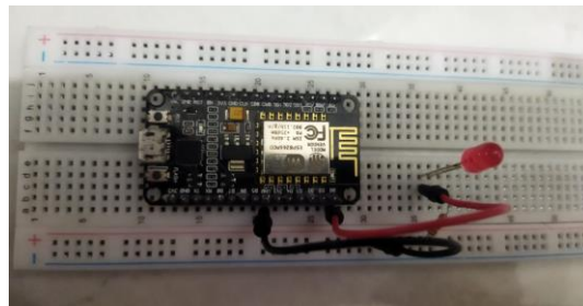
Gambar 3. 22 Hubungan LED dengan NodeMCU
