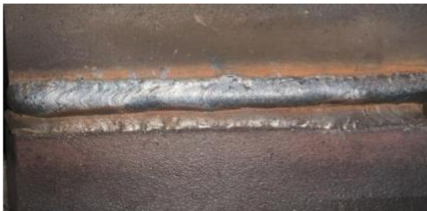
Gambar 4.3. Hasil pengelasan baja AISI 1020 arus 130A
