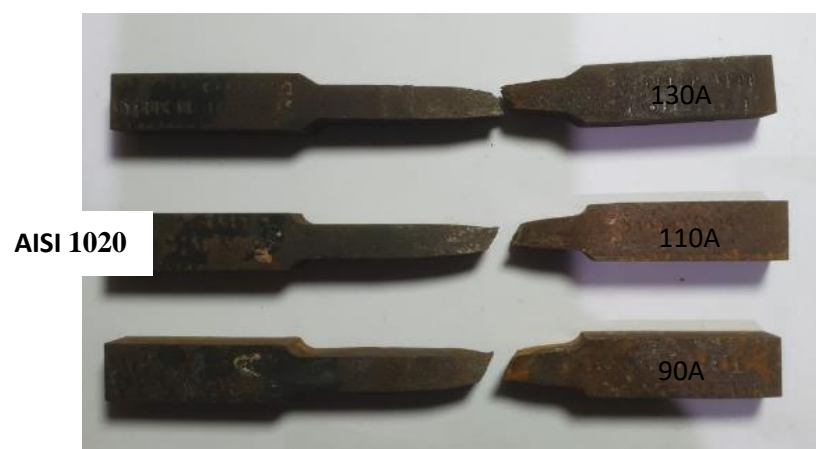
Gambar 5.8 Hasil patahan uji tarik baja AISI 1020
