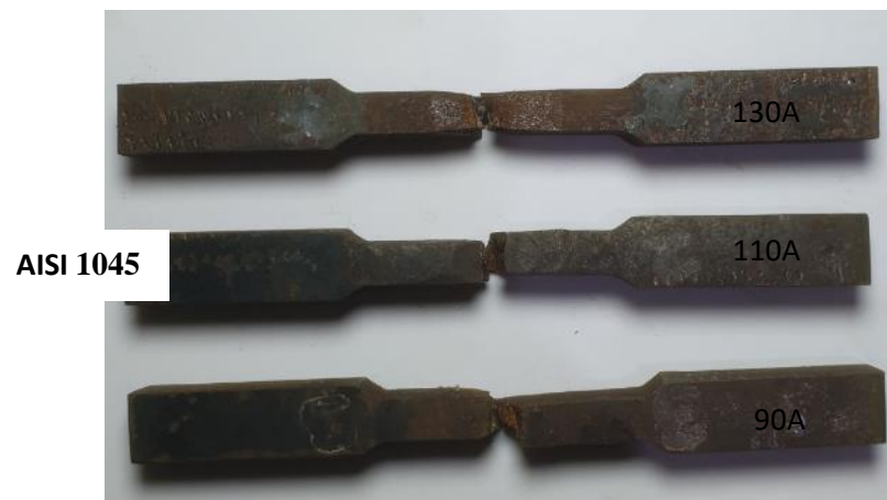
Gambar 5.9 Hasil patahan uji tarik baja AISI 1045
