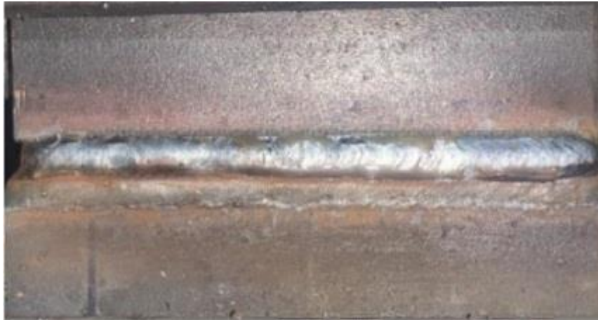
Gambar 4.4. Hasil pengelasan baja AISI 1045 arus 90A
