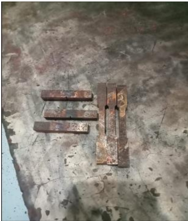
Gambar hasil pemotongan wirecut sesuai standar ASTM E8
