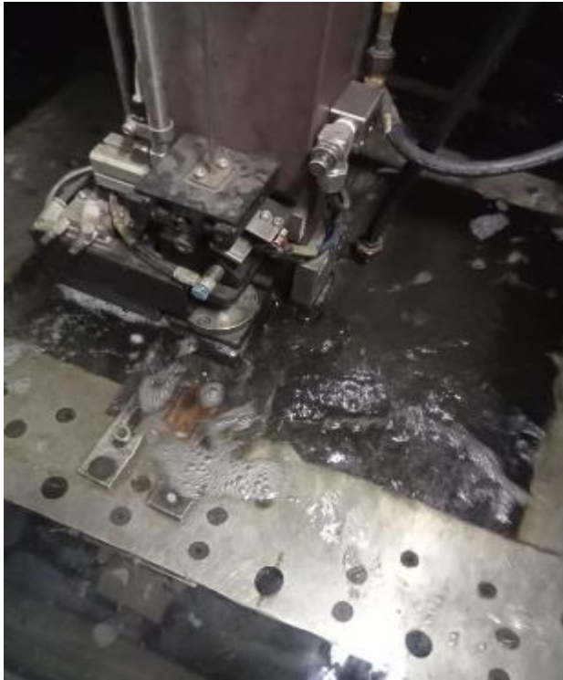
Gambar Proses pemotongan spesimen menggunakan wirecut dengan metode pendinginan rendam
