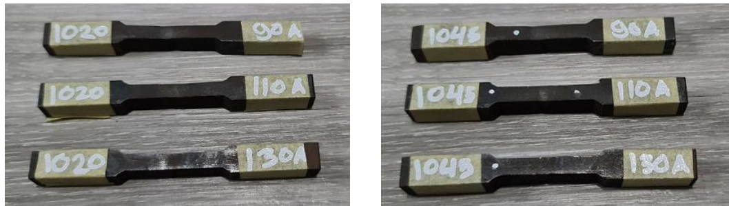
Gambar 4.7 Hasil pemotongan baja wirecut baja AISI 1020 dan AISI 1045
