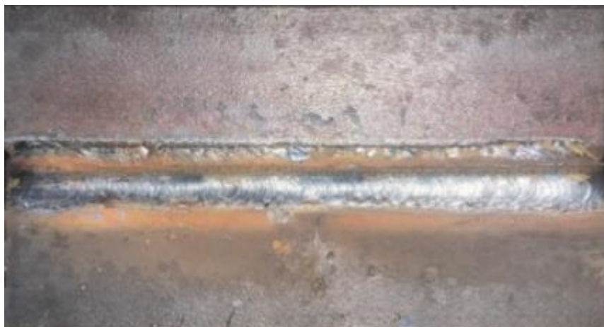
Gambar 4.6 Hasil pengelasan baja AISI 1045 arus 130A
