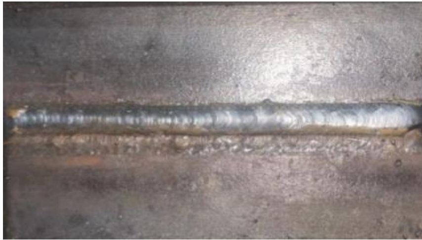
Gambar 4.5 Hasil pengelasan baja AISI 1045 arus 110A
