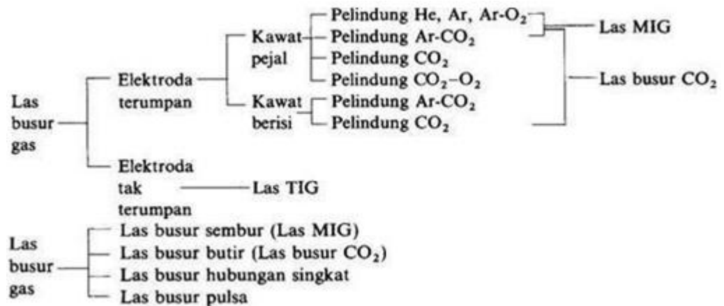
Gambar 2.4 Klasifikasi Las Busur gas
