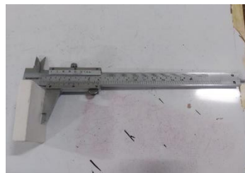
Gambar 3.32 Pengukuran Ketebalan Dengan Jangka Sorong
