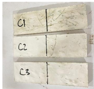
Gambar 3.36 Sampel Setelah Uji Keteguhan Lentur
