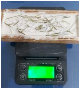
Gambar 3.25 Proses Perletakan Serat Pandan Duri Pada Lapisan Kedua
