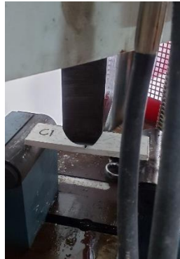
Gambar 3.34 Pengujian Keteguhan Lentur
