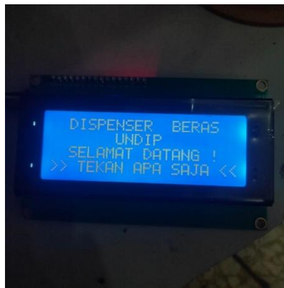
Gambar 4. 4. Hasil Pengujian LCD 20x4 I2C
