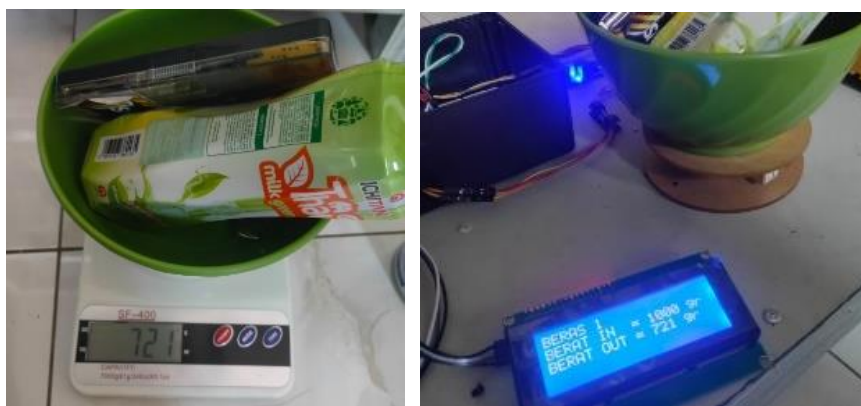
Gambar 4. 7. Pengukuran Berat Menggunakan Timbangan Konvensional dan Sensor Load Cell
