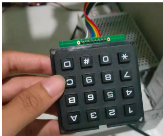
Gambar 3. 15. Pemasangan Keypad 4x4
