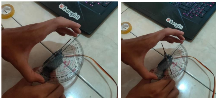
Gambar 4. 6. Pengukuran Sudut Motor Servo Menggunakan Busur Derajat
