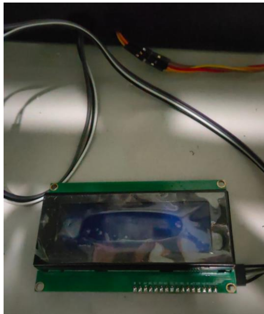
Gambar 3. 14. Pemasangan LCD 16x4 I2C
