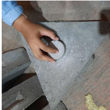
Gambar 3. 32 Meratakan Bidang Tekan pada Batako Sumber : Peneliti (2023)
