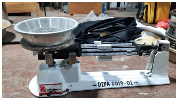
Gambar 3. 18 Proses Penimbangan Pasir Tertahan di setiap Lapis Saringan
