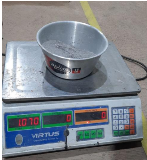
Gambar 3. 16 Proses Penimbangan 1 kg Pasir Setelah Dioven
