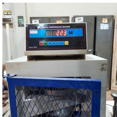
Gambar 3. 34 Proses Pengujian Kuat Tekan Batako Sumber : Peneliti (2023)
