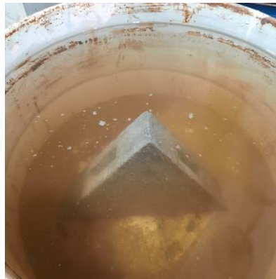
Gambar 3. 35 Proses Perendaman Benda Uji
