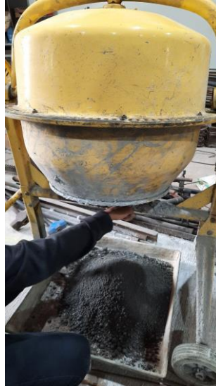
Gambar 3. 28 Proses Penuangan Adonan dari Mixer ke Wadah Sumber : Peneliti (2023)
