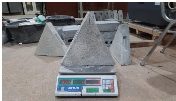
Gambar 3. 33 Menimbang Benda Uji Kuat Tekan Sumber : Peneliti (2023)
