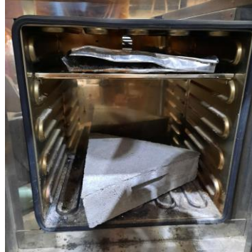
Gambar 3. 37 Memasukkan Benda Uji ke dalam Oven
