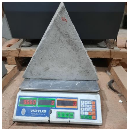
Gambar 3. 38 Menimbang Benda Uji Absorpsi dalam Kondisi Kering
