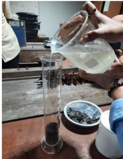
Gambar 3. 20 Proses Memasukkan Cairan NaOH kedalam Gelas Ukur
