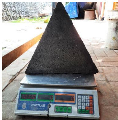
Gambar 3. 36 Menimbang Benda Uji Absorpsi dalam Kondisi Jenuh Air
