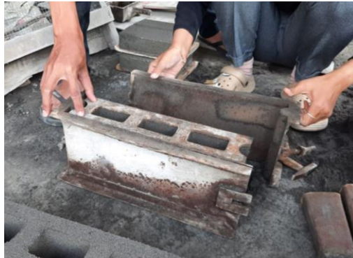
Gambar 3. 24 Proses Pelepasan Batako Konvensional Berongga dari Cetakan Sumber : Peneliti (2023)
