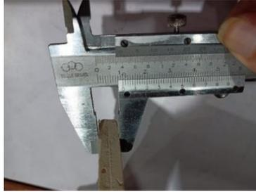
**Gambar 3. 37** Pengukuran Tebal Benda Uji
