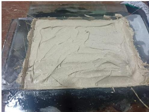
**Gambar 3. 25** Pelapisan Adonan Gypsum ke 2
