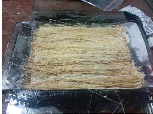
**Gambar 3. 24** Penyusunan Serat Daun Nanas di Atas Adonan Gypsum
