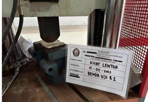
**Gambar 3. 35** Benda Uji Setelah Pengujian
