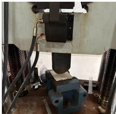
**Gambar 3. 34** Peletakan Benda Uji pada Alat UTM
