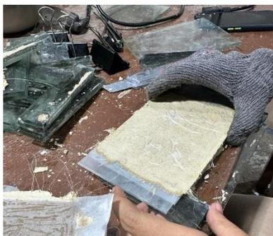
**Gambar 3. 28** Pelepasan Benda Uji
