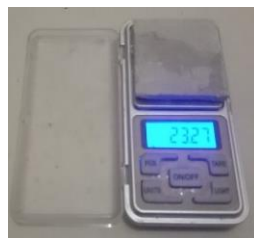
Gambar 3. 63 Pengukuran berat benda uji setelah direndam 24 jam (Sumber: Dokumentasi Pribadi, 2023)
