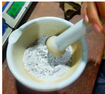
Gambar 3. 49 Proses penghalusan CKD menjadi serbuk (Sumber: Dokumentasi Pribadi, 2023)
