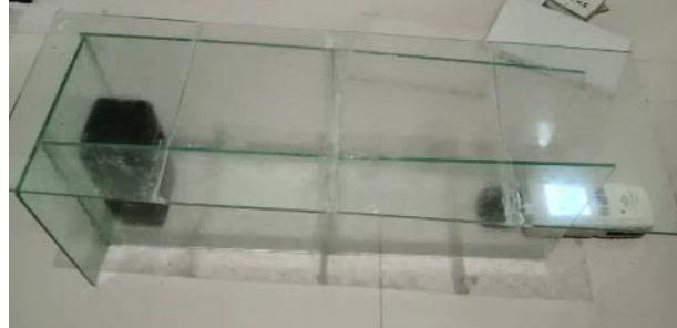
Gambar 3. 72 Proses pengujian absorpsi suara dengan papan partisi (Sumber: Dokumentasi Pribadi, 2023)
