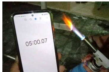
Gambar 3. 74 Proses pengujian tahan api (Sumber: Dokumentasi Pribadi, 2023)
