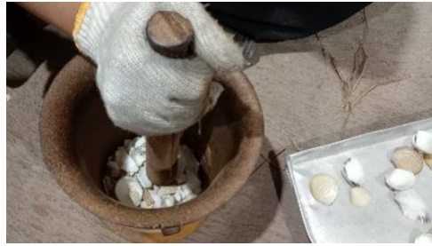
Gambar 3. 45 Proses Penumbukan CKD (Sumber: Dokumentasi Pribadi, 2023)
