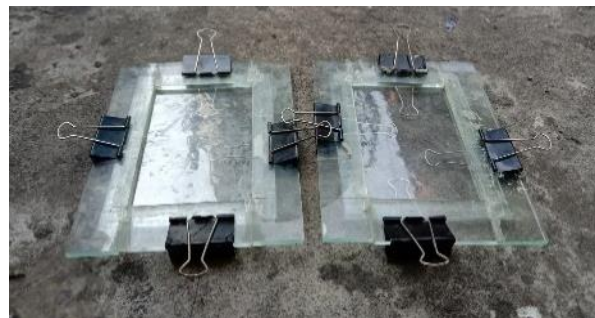
Gambar 3. 54 Proses Pengolesan Minyak ke Cetakan (Sumber: Dokumentasi Pribadi, 2023)
