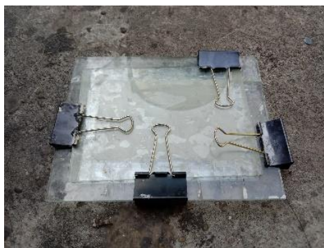
Gambar 3. 58 Proses Pemadatan Cetakan (Sumber: Dokumentasi Pribadi, 2023)
