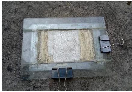
Gambar 3. 56 Proses perletakan serat dalam cetakan (Sumber: Dokumentasi Pribadi, 2023)
