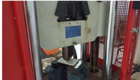
Gambar 3. 82 Perletakan benda uji pada penyangga UTM (Sumber: Dokumentasi Pribadi, 2023)
