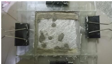
Gambar 3. 57 Proses penuangan adonan ke dalam cetakan (Sumber: Dokumentasi Pribadi, 2023)
