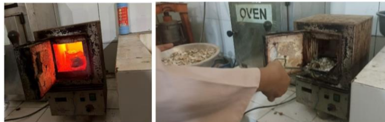
Gambar 3. 47 Proses Kalsinasi CKD (Sumber: Dokumentasi Pribadi, 2023)
