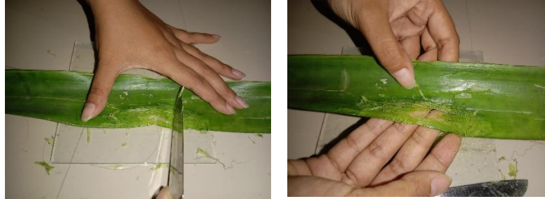
Gambar 3. 39 Scrapping Serat Daun Nanas (Sumber: Dokumentasi Pribadi, 2023)
