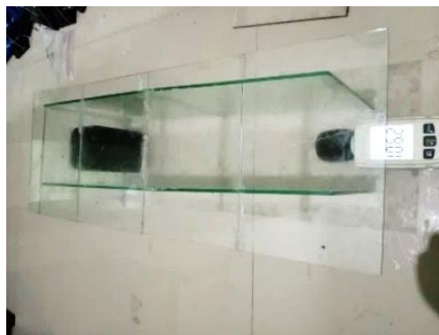
Gambar 3. 71 Proses pengujian absorpsi suara tanpa papan partisi (Sumber: Dokumentasi Pribadi, 2023)
