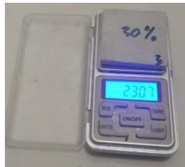
Gambar 3. 62 Pengukuran berat benda uji setelah direndam 2 jam (Sumber: Dokumentasi Pribadi, 2023)
