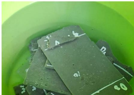
**Gambar 3.23** Pengujian Daya Serap Air
