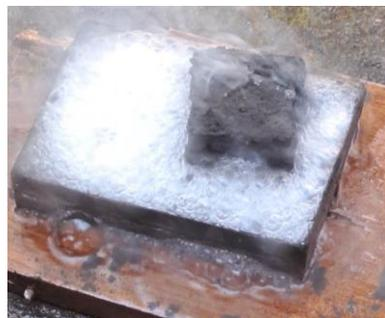
**Gambar 3.26** Kondisi Benda Uji Pada Pembakaran Suhu 1090°C
