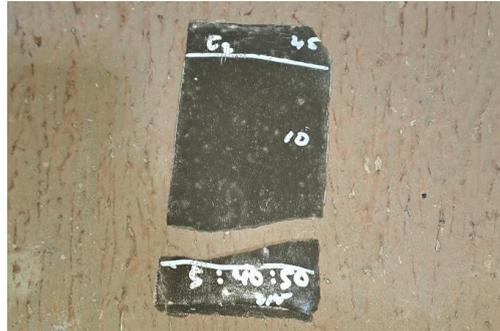
**Gambar 3.18** Kondisi Benda Uji Setelah Pengujian Kuat Tarik
