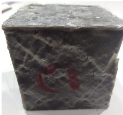
**Gambar 3.20** Kondisi Benda Uji Setelah Pengujian Kuat Tekan
