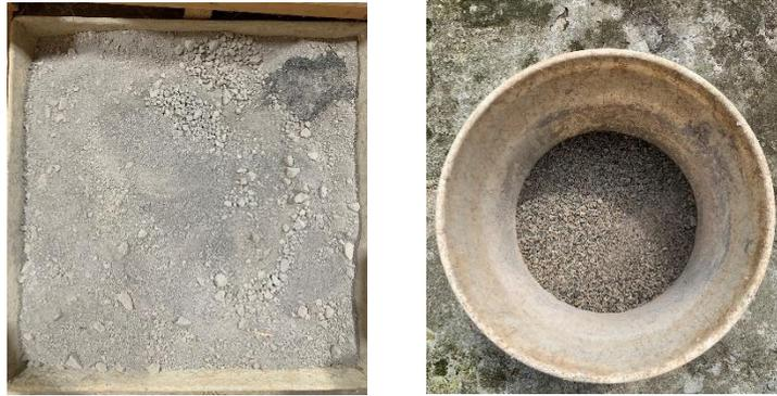
**Gambar 2.4.** Agregat Halus Pasir, Agregat Halus Abu Batu
