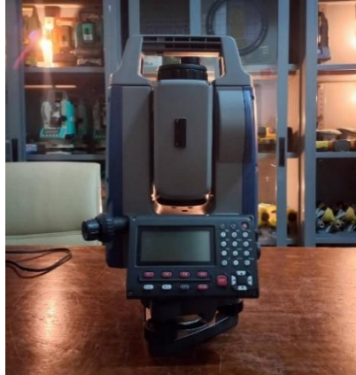
Gambar I-16 Total Station Reflectorless SOKKIA IM 52
