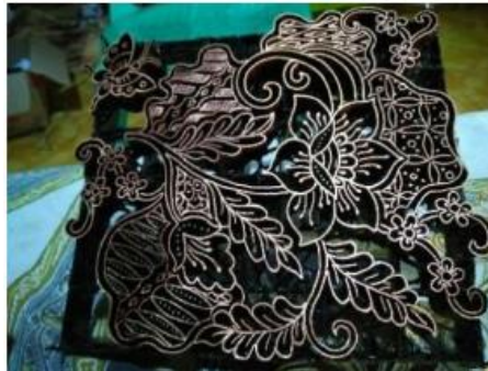
Gambar 2. 8 Alat Cap Untuk Batik Cap
