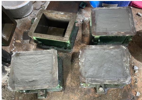
Gambar 4.20 Memasukan Beton ke Cetakan
