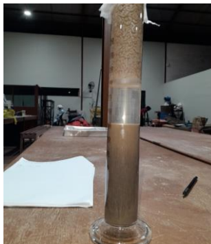
Gambar 3. 32 Hasil pengujian kadar lumpur metode kocokan
