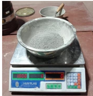
Gambar 3. 19 Penimbangan pasir kering
