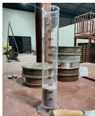
Gambar 3. 24 Pasir setinggi 130 ml dalam gelas ukur
