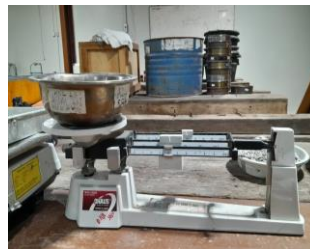
Gambar 3. 14 Proses menimbang cawan
