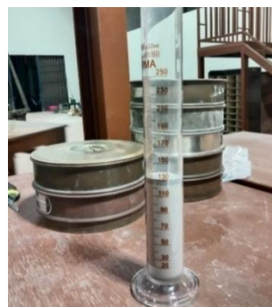
Gambar 3. 29 Pasir setinggi 130 ml dalam gelas ukur
