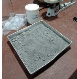
Gambar 3. 18 Pasir setelah di- oven
