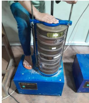
Gambar 3. 20 Proses pengayakan pasir
