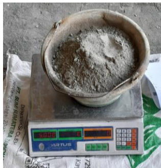
Gambar 3. 35 Proses penimbangan semen
