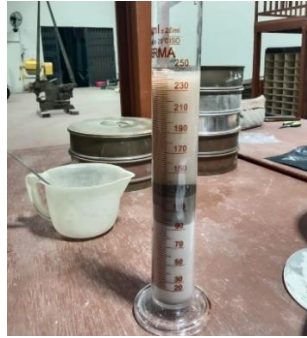
Gambar 3. 30 Pasir dan air dalam gelas ukur
