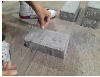
Gambar 3. 48 Pemeriksaan dimensi/ ukuran paving block
