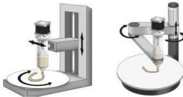
Gambar 2. 2 3D printer model polar (kiri) dan scara (kanan)
