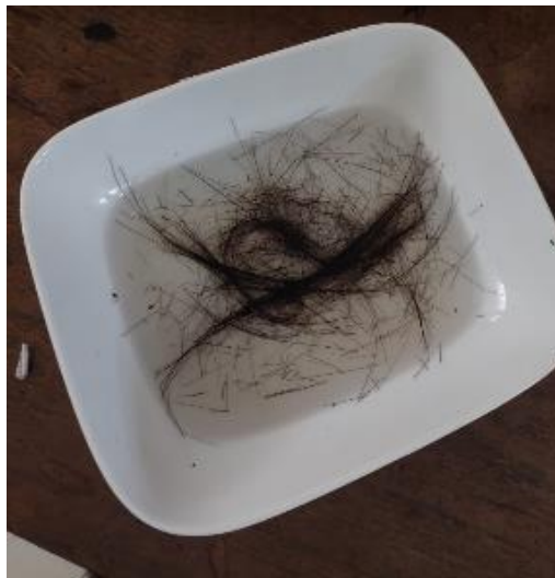
Gambar 4. 1 Perlakuan alkali pada serat kelapa
