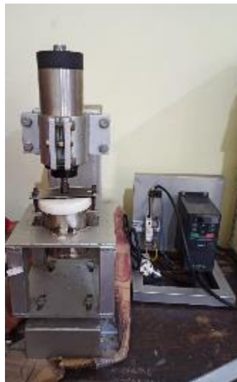
Gambar 3.11. Alat pengaduk putaran tinggi
