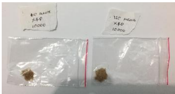
Gambar 3.44. Preparasi sampel XRD
