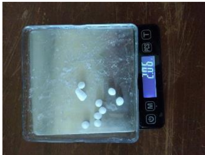
Gambar 3.37. Mengukur berat alkali untuk spesimen
