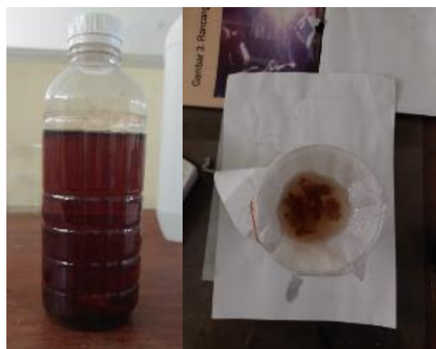
Gambar 4. 3 Pengendapan dan penyaringan serat kelapa
