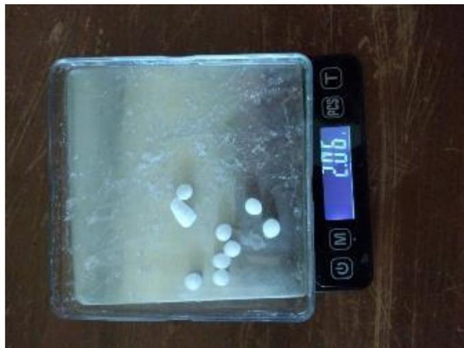
Gambar 3.41. Mengukur berat alkali untuk spesimen
