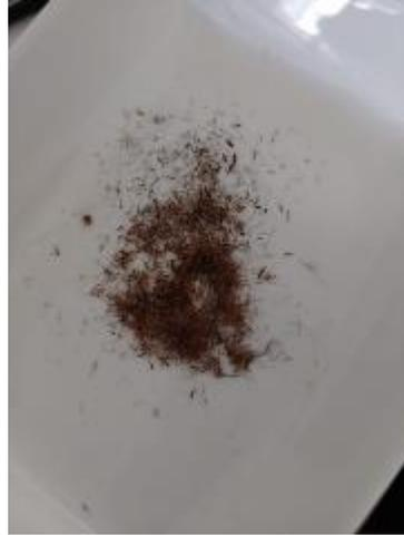
Gambar 3.44. Pemotongan serat aren
