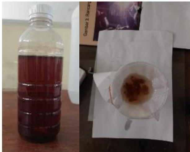
Gambar 4.3. Pengendapan dan penyaringan serat aren
