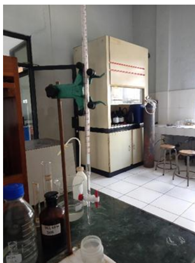
Gambar 3. 10 Alat Titrasi Untuk Analisa Bilangan Iod
