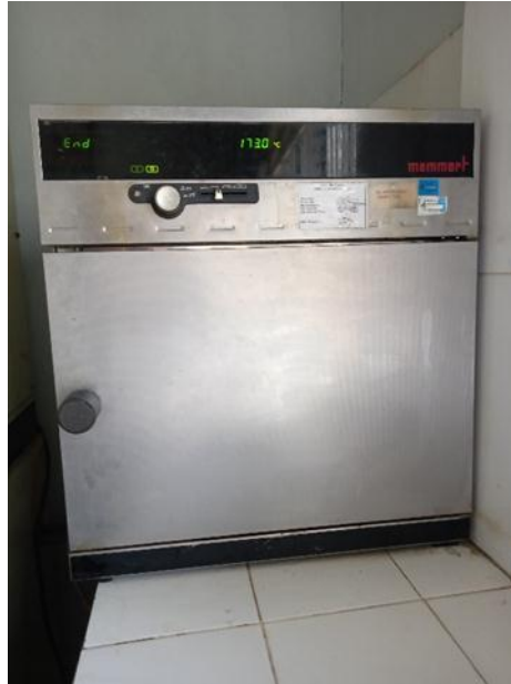
Gambar 3. 6 Oven untuk Analisa Sisa Penguapan
