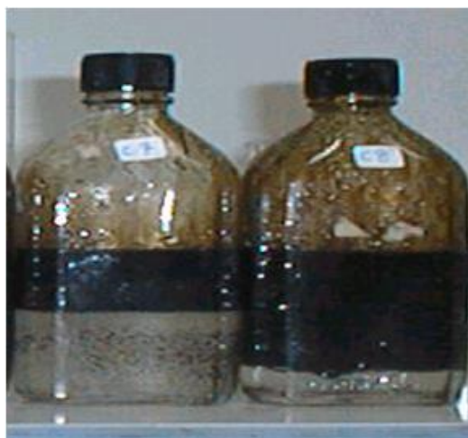
Gambar 5 Contoh botol tes dengan dosis demulsifier yang berbeda (PT.Clariant Indonesia, 2013 )
