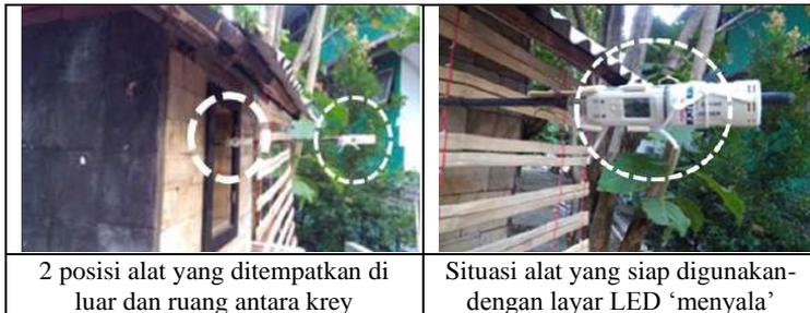
**Gambar 2.4:** Penempatan alat thermal data logger pada obyek Rumah Model
