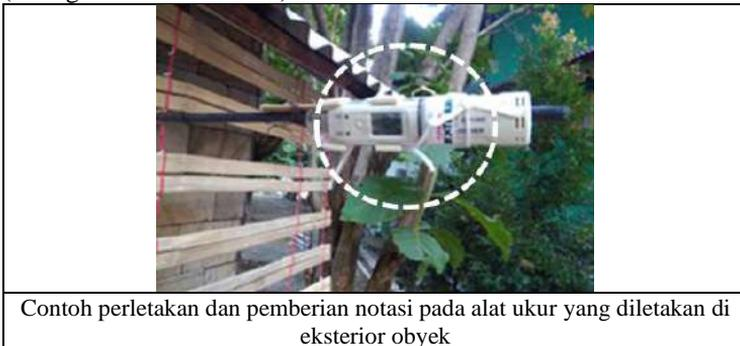
**Gambar 3.5:** Penempatan alat thermal data logger pada area eksterior obyek Rumah Model
