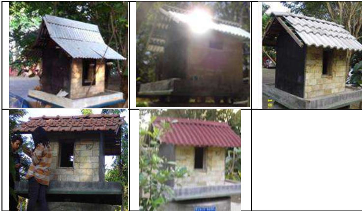
Gambar 5.2: Model praktikum dengan ragam material atap.
