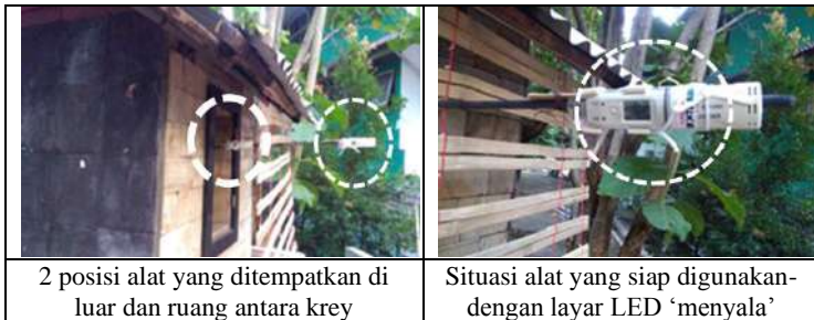
Gambar 1.3: Penempatan alat thermal data logger pada obyek Rumah Model
