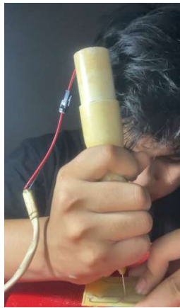
Gambar 4. 1 Proses Pengeboran PCB
