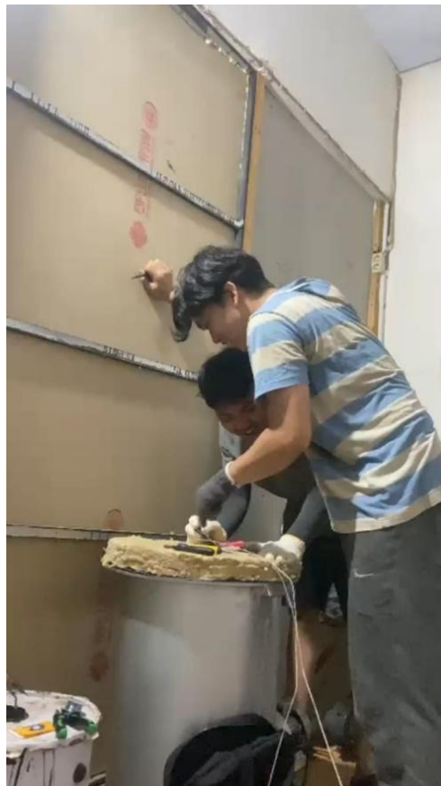
Gambar 4. 1 Proses Pengerjaan Mekanikal Prototipe Sand Battery
