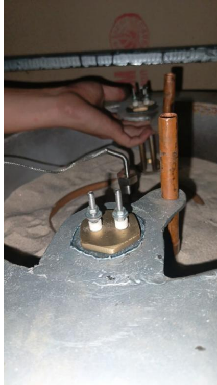
Gambar 4. 3 Pemasangan Dua Elemen Pemanas pada Penutup Tabung
