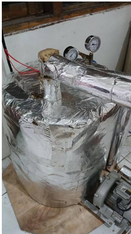
Gambar 4. 5 Hasil Akhir Perakitan Mekanikal Prototipe Sand Battery
