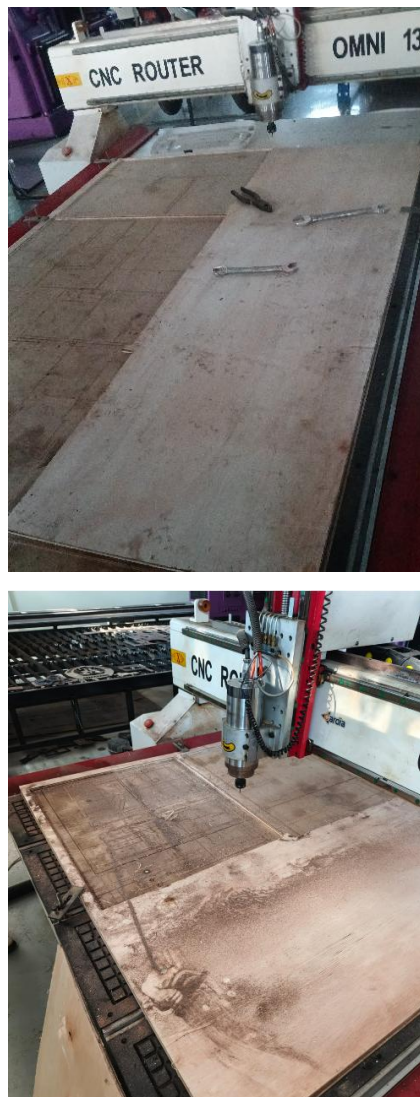
Gambar 4. 6 Pemotongan Triplek menggunakan CNC
