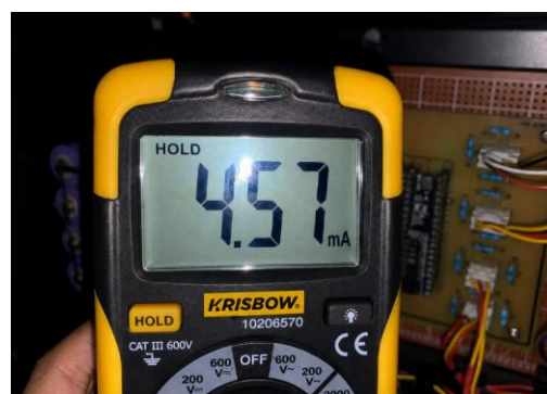
Gambar 4. 36 Kalibrasi Sensor INA219 parameter Arus
