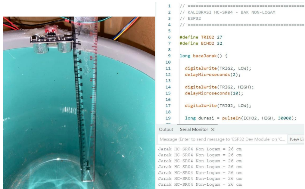
Gambar 4. 34 Kalibrasi sensor HC-SR04 pada Bak NonLogam
