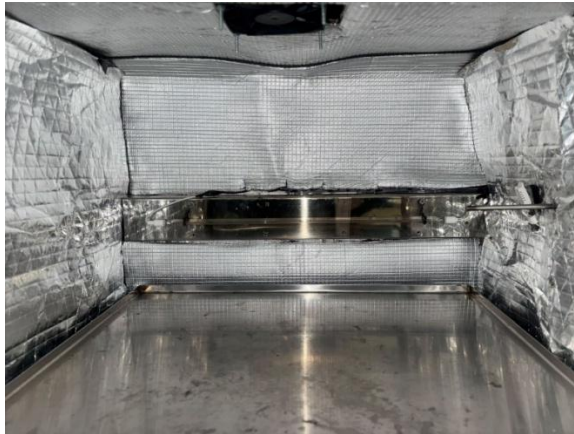
Gambar 4. 2 Ruang Pengering dan Penempatan Heater
