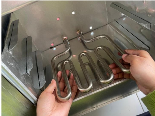
Gambar 4- 2 Proses Pemasangan Elemen Pemanas ( Heater ) pada Dehydrator
