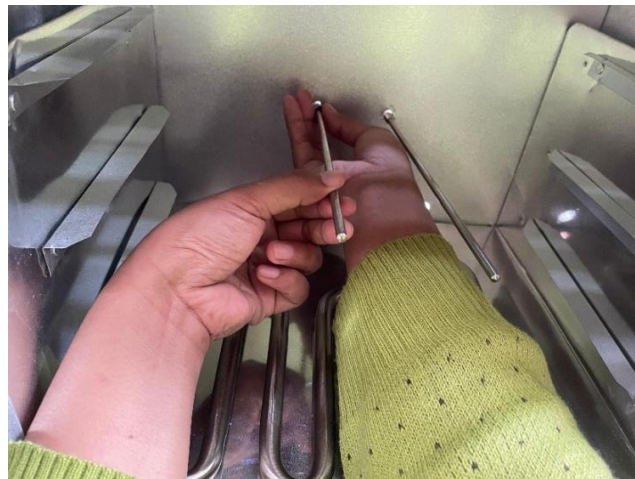
Gambar 4- 3 Proses Pemasangan Sensor Thermocouple pada Dehydrator
