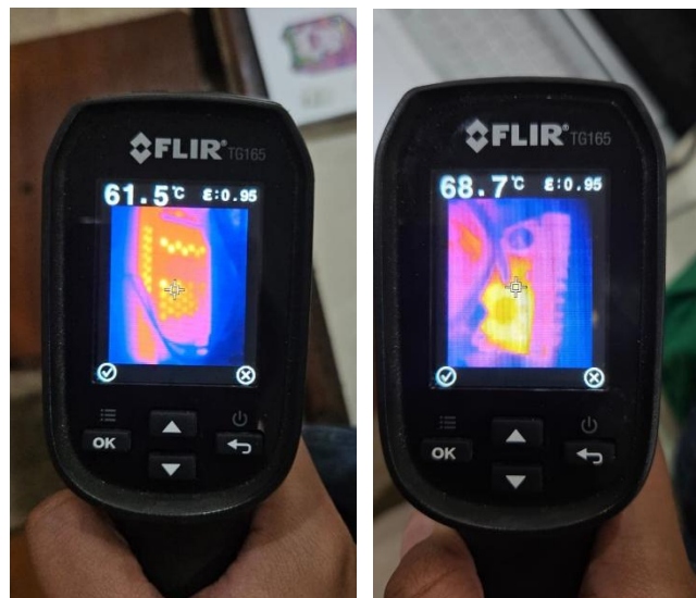
Gambar 5- 7 Proses pengukuran suhu komponen menggunakan thermal gun
