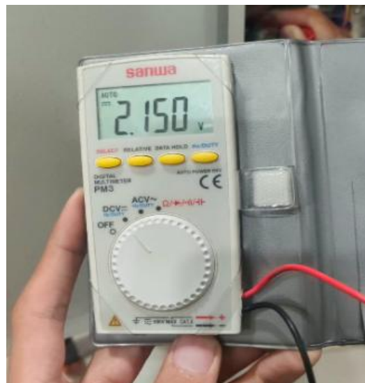
Gambar 4.22 Hasil Pengukuran Tegangan Keluaran RC Low-Pass Filter pada PWM 44.000
