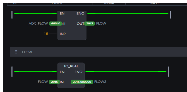
Gambar 4.14 Perubahan Variabel pada OpenPLC
