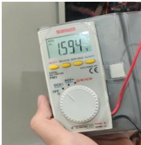
Gambar 4.20 Hasil Pengukuran Tegangan Keluaran RC Low-Pass Filter pada PWM 32.000
