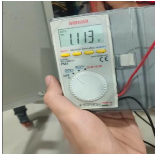
Gambar 4.18 Hasil Pengukuran Tegangan Keluaran RC Low-Pass Filter pada PWM 22.000
