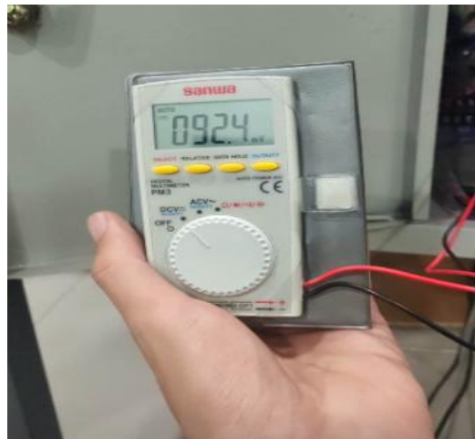
Gambar 4.16 Hasil Pengukuran Tegangan Keluaran RC Low-Pass Filter pada PWM 0
