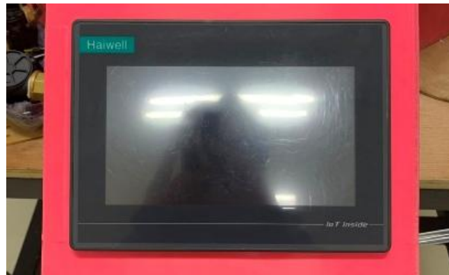
Gambar 4. 3 Pemasangan HMI Haiwell pada Dudukan 3D Print
