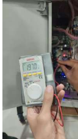
Gambar 4.5 Pembacaan Arus PWM 40000 OpenPLC
