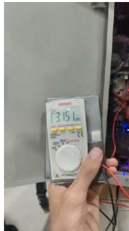
Gambar 4.7 Pembacaan Arus PWM 65535 OpenPLC
