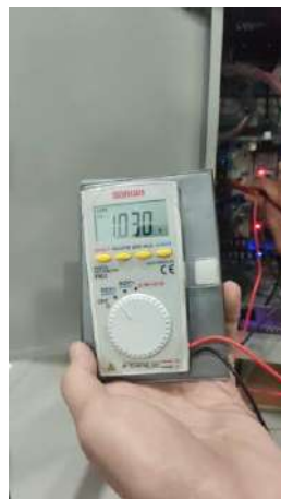
Gambar 4.3 Pembacaan Arus PWM 20000 OpenPLC
