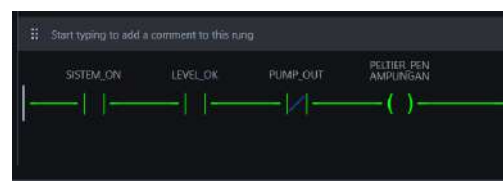
Gambar 4.30 Kondisi Ladder dan Peltier Penampungan ON
