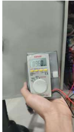
Gambar 4.1 Pembacaan Arus PWM 0 OpenPLC
