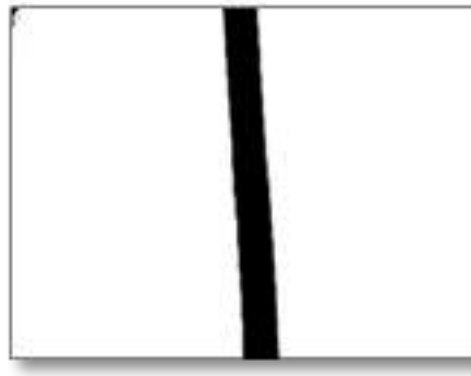
Gambar 2.3 Hasil binerisasi citra rambut tunggal menggunakan nilai ambang Otsu T = 97 [7]
