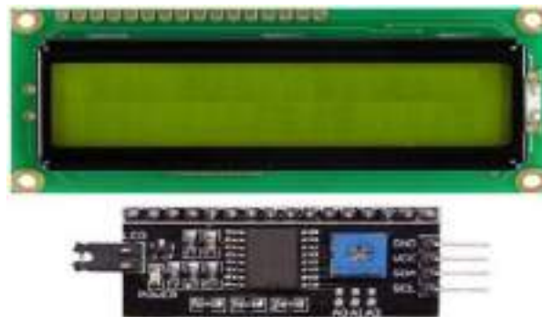
Gambar 2.10 LCD 16×2 dengan modul antarmuka I 2 C [32]
