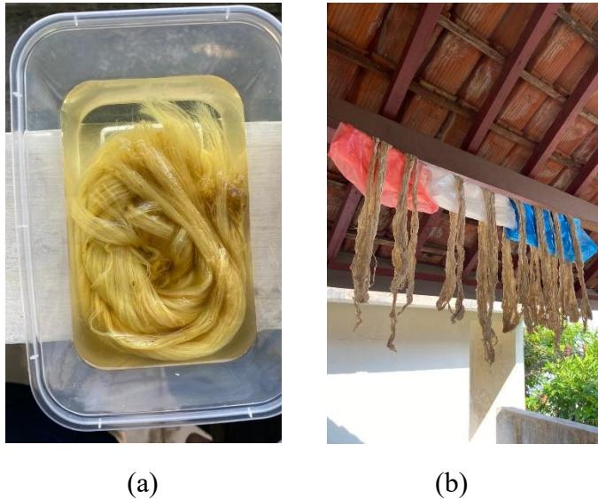
Gambar 4.2 Serat yang direndam larutan NaOH (a), dan serat yang sudah direndam sedang dijemur (b)
