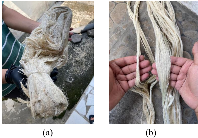
Gambar 4.1 Serat yang belum dilakukan penyisiran (a), dan serat yang sudah dilakukan penyisiran (b)
