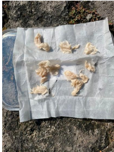
Gambar 4.5 Serat nanas setelah perlakuan ledakan uap
