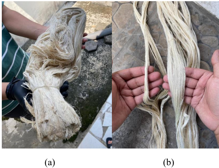
Gambar 4.1 (a) Serat sebelum disisir, (b) Serat sesudah disisir
