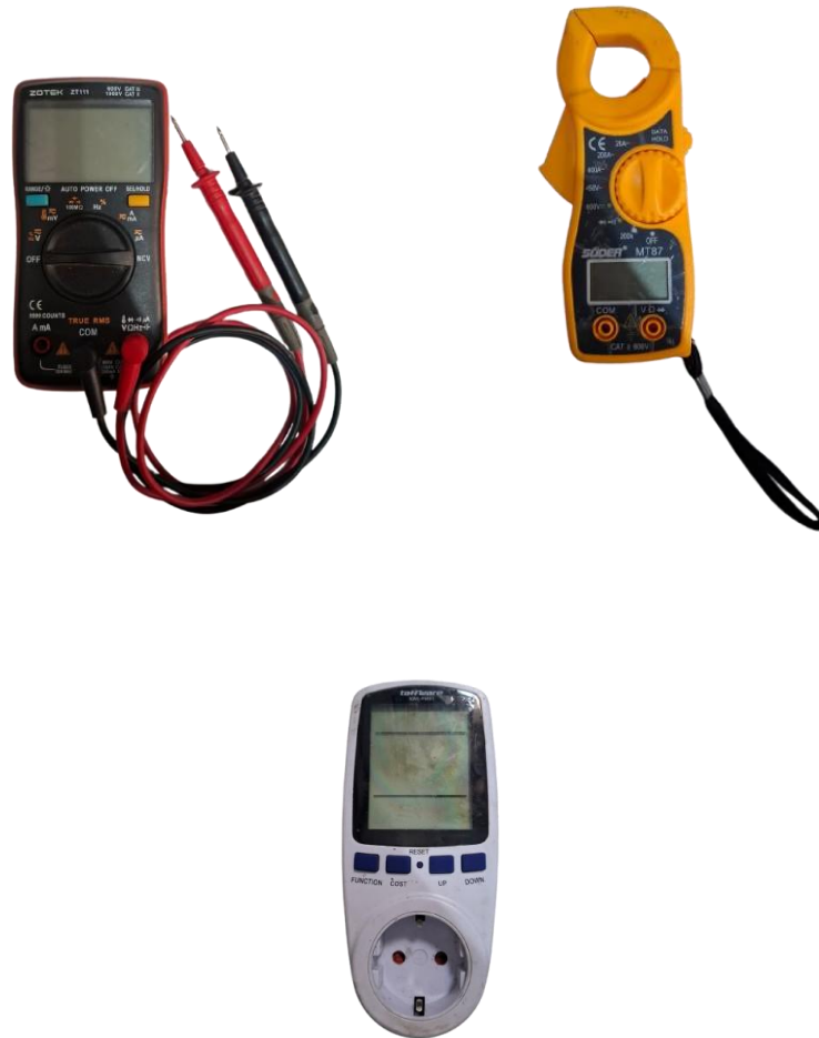
Gambar 4. 3 Multimeter, clampmeter dan display listrik
