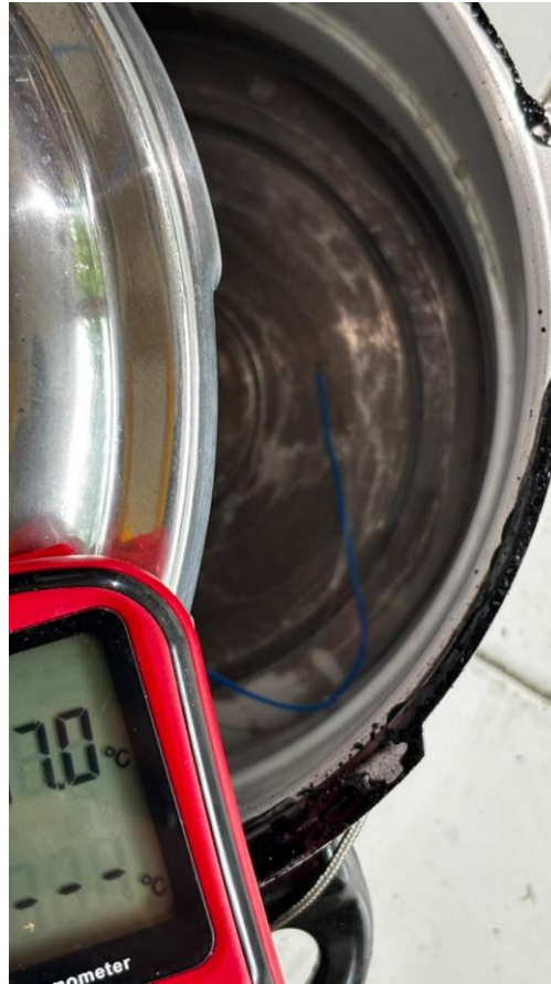
Gambar 4.9 Cara pemasangan probe temperature
