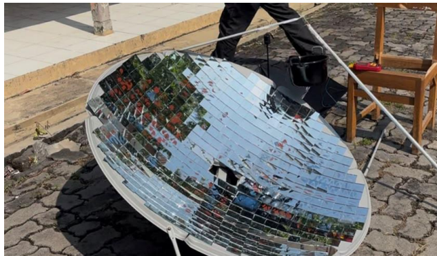
Gambar 4.5 Hasil pemasangan kaca reflektor pada permukaan parabola
