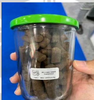
Gambar 2. 5 Produk Pelet dari Pelepah Kelapa Sawit
