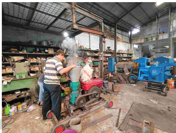
Gambar 2. 4 Mesin Produksi Pembuat Pelet
