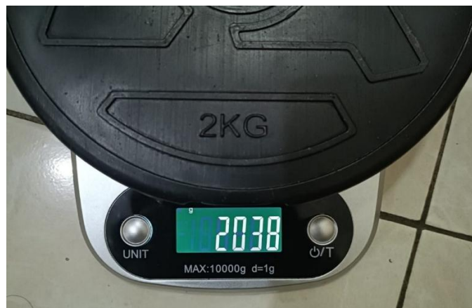
Gambar 4. 5 Hasil Pengujian Repeatability Load cell (Beban Referensi: 2038 Gram)
