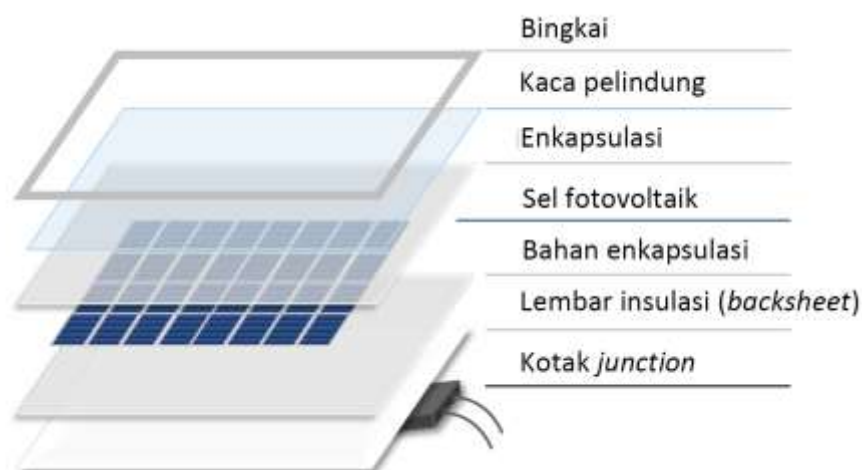
Gambar 2. 2 Susunan Lapisan Modul PV
