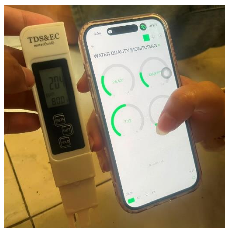
Gambar 5. 4 Gambar Pengujian Sensor TDS pada TDS Meter
