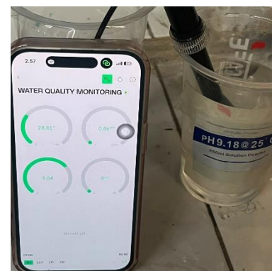
Gambar 5.3 Gambar Pengujian Sensor pH pada Larutan pH Buffer
