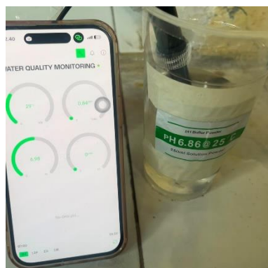
Gambar 5.3 Gambar Pengujian Sensor pH pada Larutan pH Buffer
