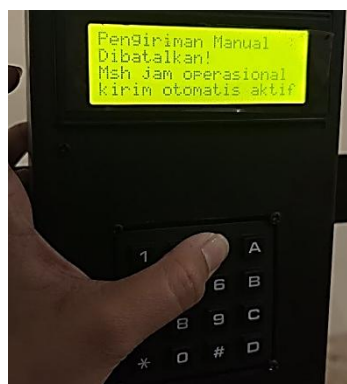
Gambar 5.9 Tampilan LCD saat Pengiriman Manual Ditolak karena Masih Jam Operasional
