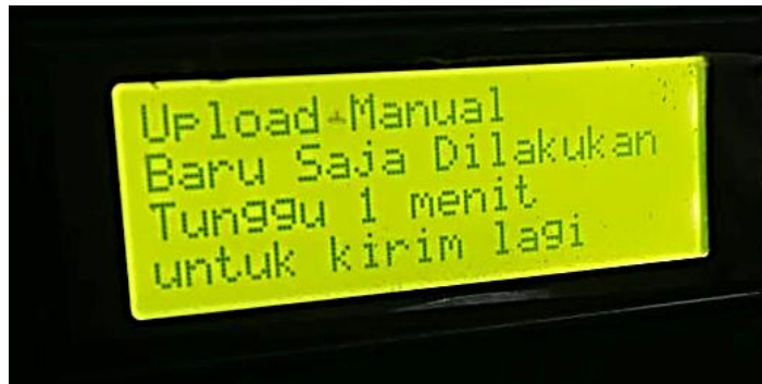
Gambar 5.10 Tampilan LCD saat Pengiriman Manual Ditolak karena Cooldown 1 Menit Belum Selesai
