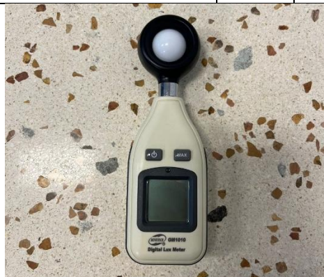
Gambar 5.1 Pengujian Sensor BH1750 Menggunakan Lux Meter
