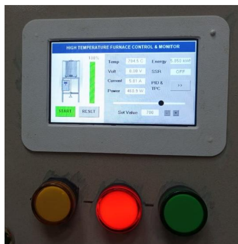
Gambar 4. 13. Jika Pilot Lamp Merah Menyala sebagai Indikator Hasil Tidak Efisien
