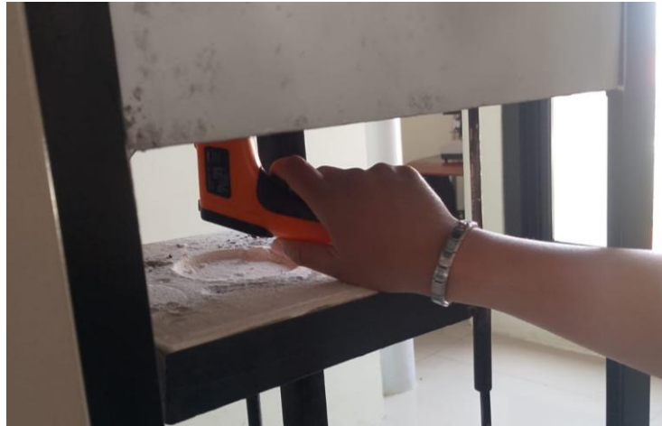
Gambar 4. 3. Proses Pengujian Thermocouple Tipe K Menggunakan Thermogun
