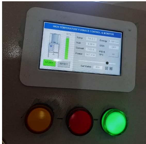
Gambar 4. 12. Pilot Lamp Hijau Menyala sebagai Indikator Hasil Efisien
