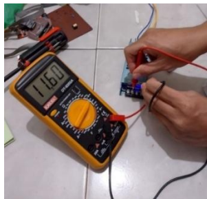
Gambar 4. 1 Pengukuran Output Tegangan Catu Daya Menggunakan Multimeter
